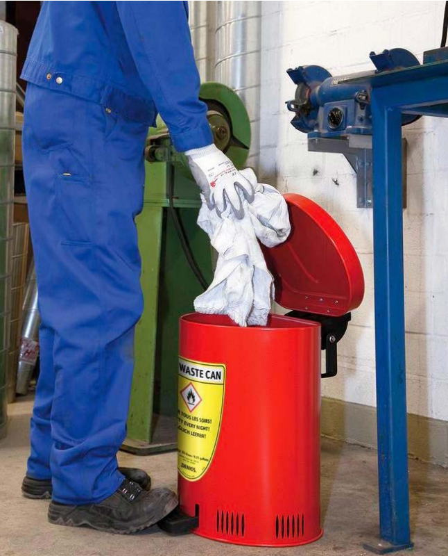
Abb. 27 Metallbehälter zur Sammlung für lösemittelgetränkte Putzlappen
