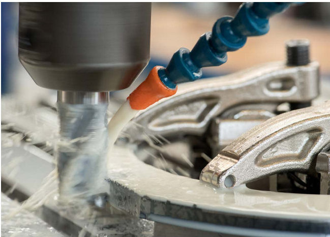
Abb. 23 Kühlschmierstoffanwendung an einer Drehbank
